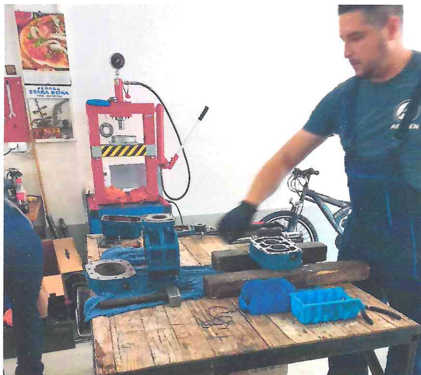
Slika 5. Početak radova na servisiranju duvaljki
